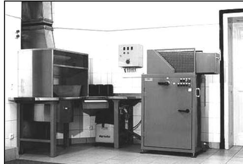
Der gesamte Kremationsvorgang eines Verstorbenen wird dokumentiert: Name, Kremations-Nummer, Beginn und Ende der Kremation, Einäscherungstemperatur, Abgaswerte, ... -> Kontrolle bei Störung!
